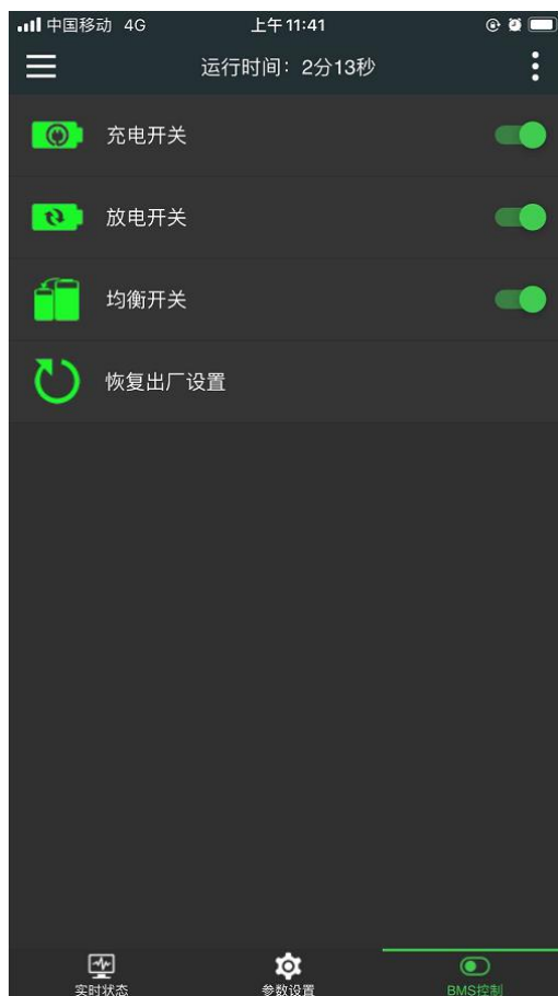
图 34 BMS 控制页面
